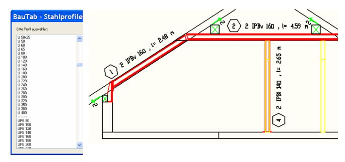
Mit dem Befehl PROFILIST erfolgt ein automatischer Stahllistenauszug in die Profilstahl-Liste: ILL ILL ILL INIZ HOLZ HOLZ
