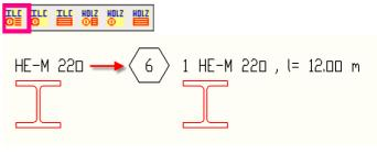
Mit diesen Befehlen ist nun im Holz- und Stahlbaubereich eine schnelle Massenschätzung bei geplanten Projekten direkt aus der Zeichnung heraus möglich.
